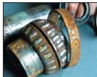
Rodamientos contaminados por humedad.
