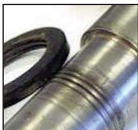
Daños en un eje ocasionados por un anillo de laberinto
